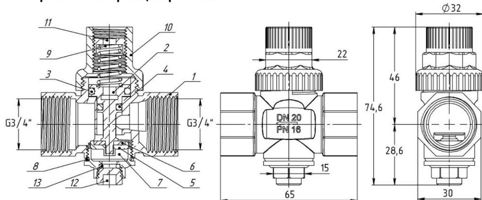
3.1 Поддержание выходного давления рабочей среды в заданных параметрах достигается путём изменения проходного сечения корпуса узлом клапан-шток через воздействие входного давления и пружины.
