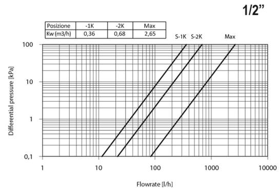
894C - 895C - 894V - 895V В СОЧЕТАНИИ С ИСПОЛНИТЕЛЬНЫМ МЕХАНИЗМОМ СЕРИИ 891:
