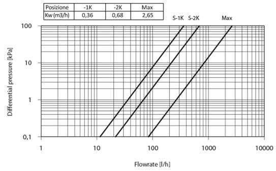
894C - 895C - 894V - 895V В СОЧЕТАНИИ С ИСПОЛНИТЕЛЬНЫМ МЕХАНИЗМОМ СЕРИИ 891:
