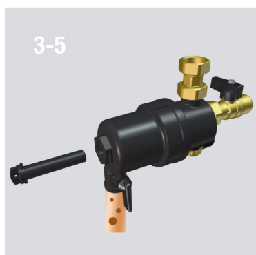
Демонтаж магнита (поверните на 90° по часовой стрелке)
