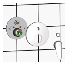
Наденьте накладку поверх картриджа и переключателя и закрутите в правильной позиции. Затем смонтируйте внешнюю
