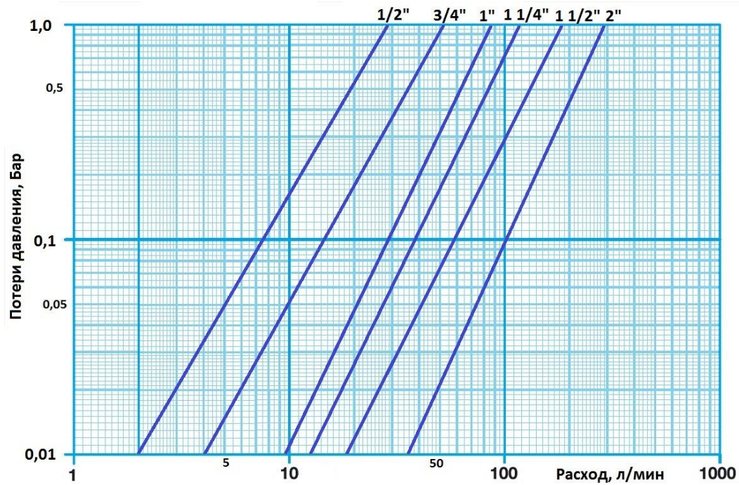
Рис 2. График зависимости сопротивления от расхода.
